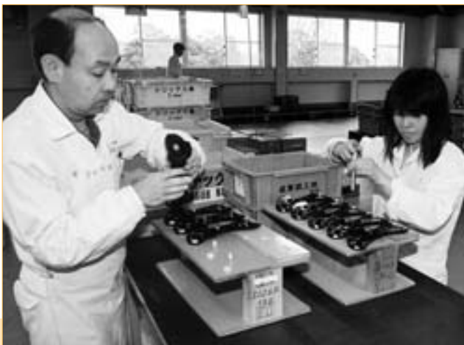
バッテリープレート、キャニスター、サブフレーム、ブレーキホースなど1人1工程で作業を進めている
