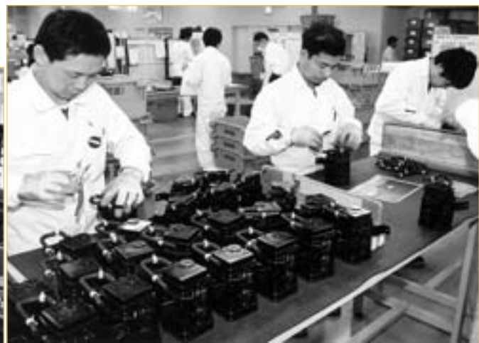
バッテリープレート、キャニスター、サブフレーム、ブレーキホースなど1人1工程で作業を進めている
