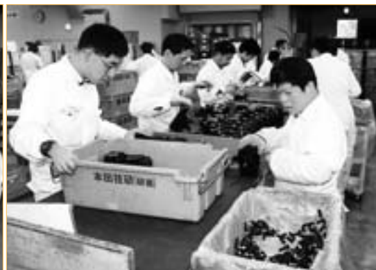
バッテリープレート、キャニスター、サブフレーム、ブレーキホースなど1人1工程で作業を進めている
