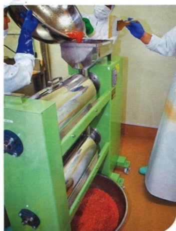
バルパーフィニッシャーは、煮たトマトを上から注ぐと、銀色の円筒形の部分で搾られる仕組みだ
