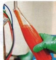
瓶に詰める作業。ペダルを踏むと、定量が自動的に注入される
