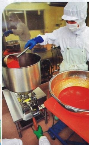
瓶に詰める作業。ペダルを踏むと、定量が自動的に注入される
